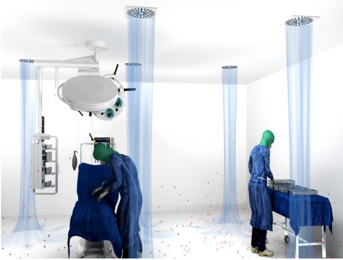
Traditionelle Zuluft Decken wirken nur sehr punktuell
